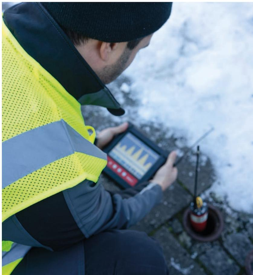
Ein Mitarbeiter der Stadtwerke wertet die Daten der Bodenmikrofone mit einem Korrelator aus.
