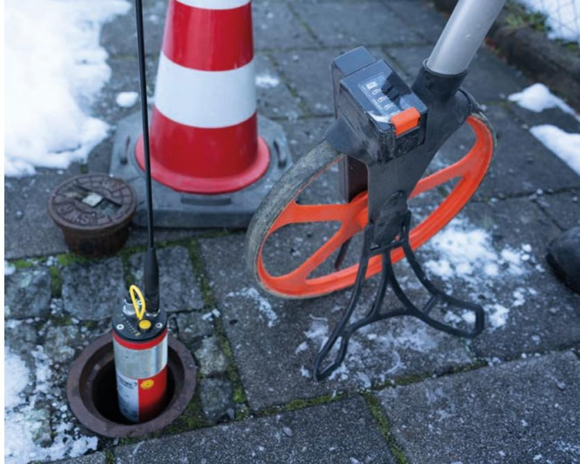
Mittels der Geräuschmessung, können Wasserrohrbrüche ermittelt werden, denn austretendes Wasser erzeugt Geräusche.
