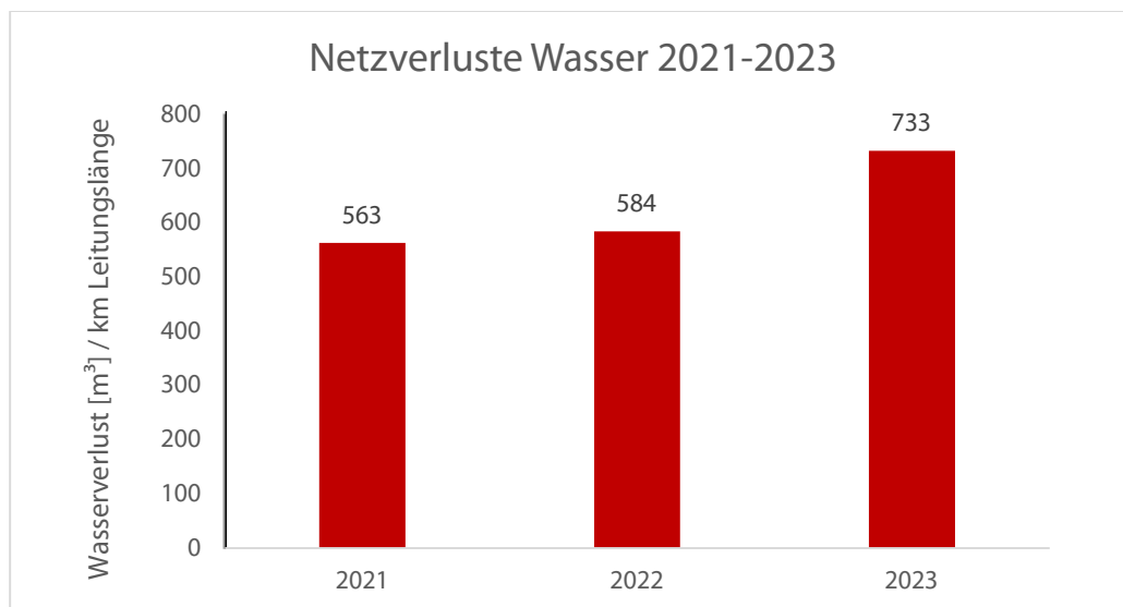
Abbildung 3: Grafik Wasserverluste pro km Leitungslänge
