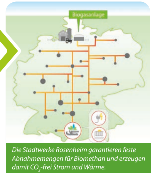
Biogas wird zu Biomethan und kann so in das deutsche Erdgasnetz eingespeist werden.
