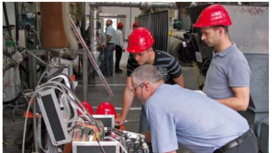
Axel Kühnert (vorne) von der Fa. Eheim Messtechnik GmbH erläutert Ingenieuren der FH Zittau-Görlitz das Gerät zur Online-Messung der Gaszusammensetzung.
