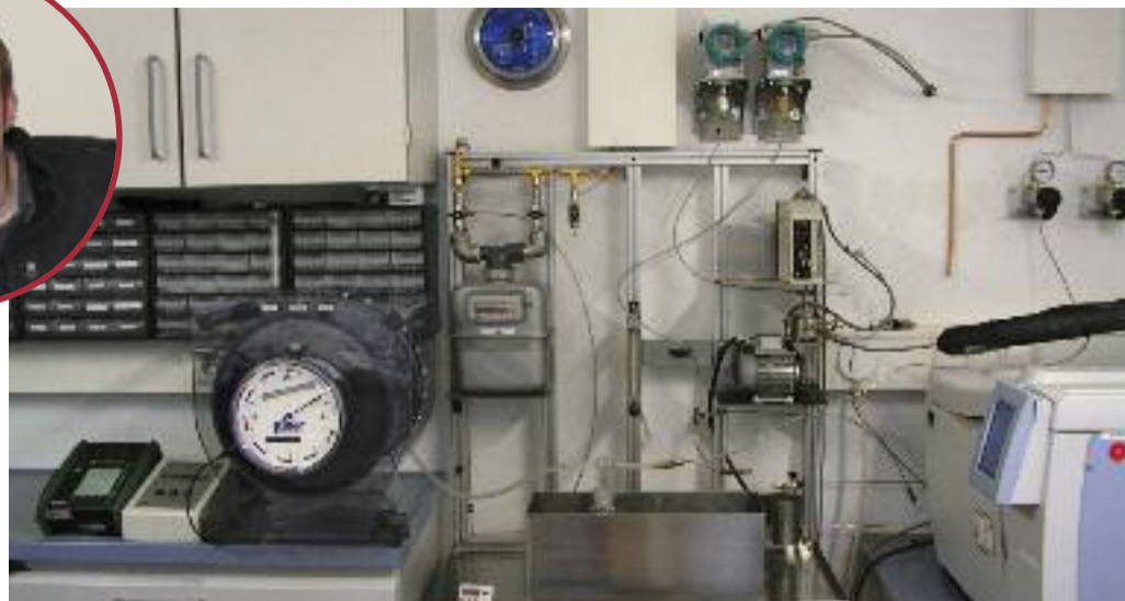
Der Versuchsaufbau zur vereinfachten Benzolmessung im eigenen Labor der Stadtwerke.
