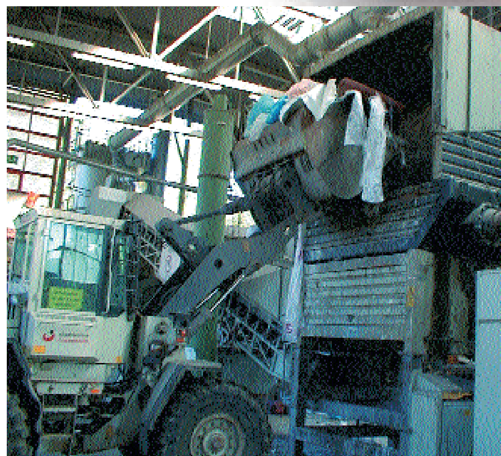
... mit dem Radlader geht es in die Zerkleinerung.
